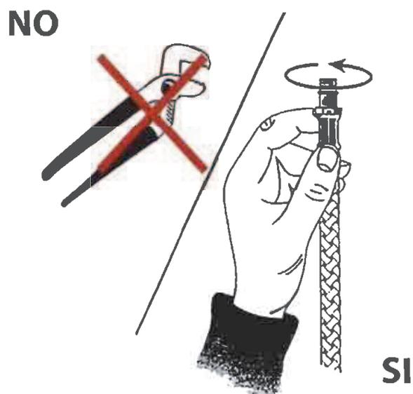
L'attacco flessibile con raccordino maschio filettato con OR da avvitare al rubinetto monocomando miscelatore, monoforo, ecc...
