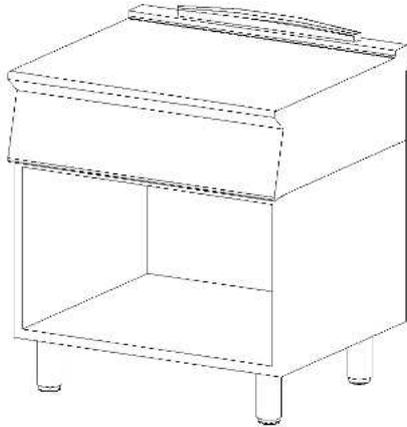
Piano di lavoro in acciaio spessore 2 mm senza foro camino utilizzabile per le lavorazioni e gli appoggi
